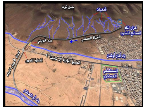
الشكلان رقم 3 و4: القناة السفلى والعليا لحماية مدينة كلميم من الفيضانات المصدر: الجماعة الحضرية لكلميم، 2012.
