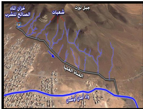
الشكلان رقم 3 و4: القناة السفلى والعليا لحماية مدينة كلميم من الفيضانات المصدر: الجماعة الحضرية لكلميم، 2012.
